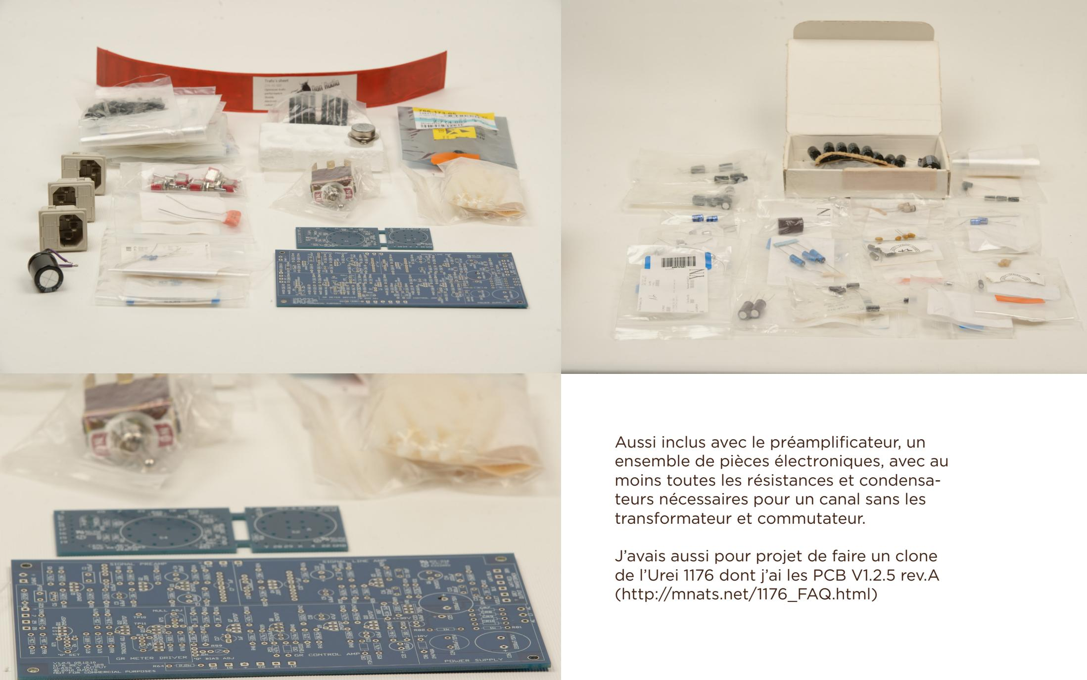
Aussi inclus avec le préamplificateur, un ensemble de pièces électroniques, avec au moins toutes les résistances et condensateurs nécessaires pour un canal sans les transformateur et commutateur.
