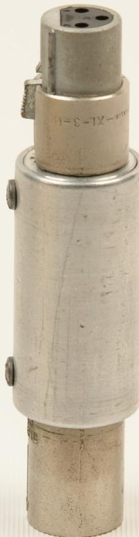
L'adaptateur alimentation fantôme est très utile puisqu'il permet de se passer de l'alimentation originale à condition de recevoir une alimentation 48V depuis le préamplificateur.
