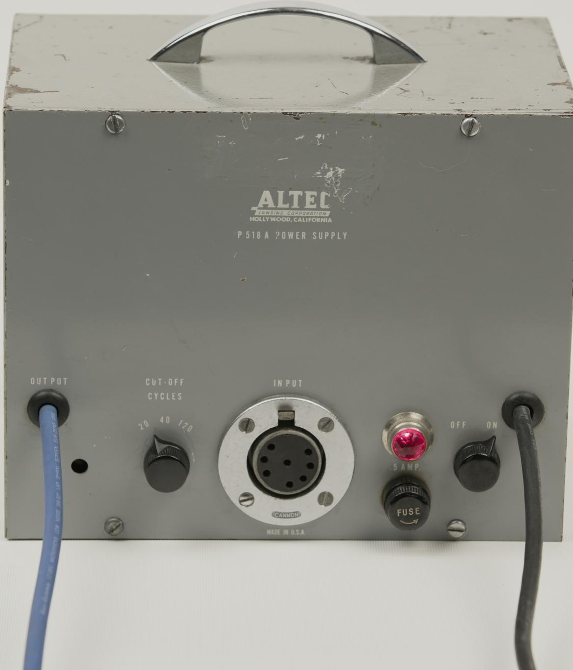
Le câble originel bien que fonctionnel a été remplacé par un câble neuf, les connectiques CANON sont originales.
